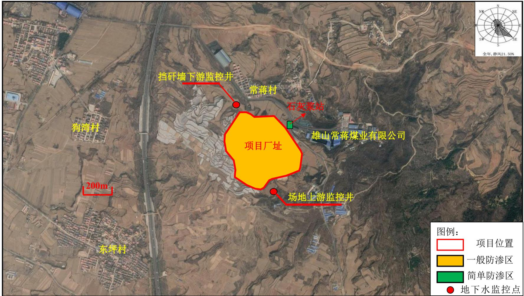
图 5.3-2 地下水监控点位示意图及防渗分区图
