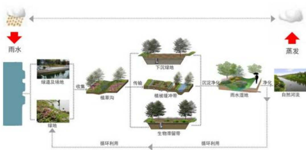
图 2-5 海绵工程流程图
