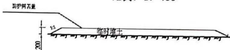
临时堆土防护纵断面图
