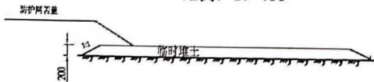
临时堆土防护纵断面图
